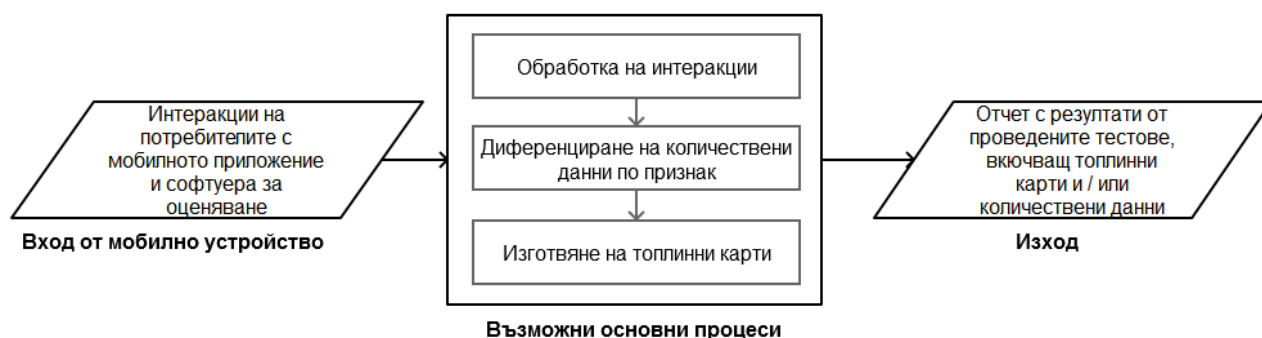
Фиг. 1. Концептуален функционален модел на прототип на система за оценяване на достъпността на мобилни приложения
