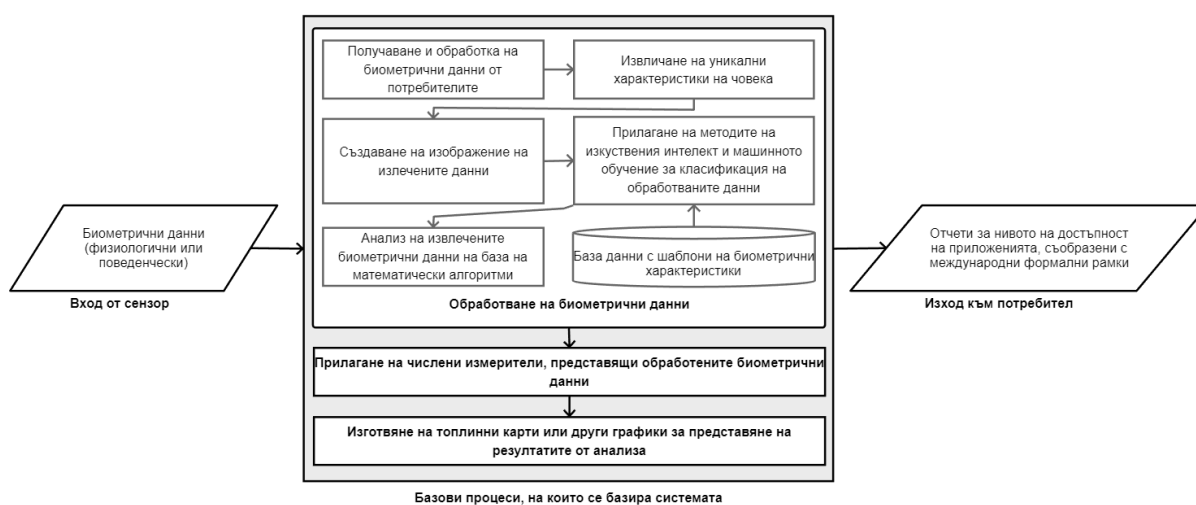
Фиг. 2. Концептуален функционален модел на прототип на система за оценяване на достъпността на мобилни приложения, работеща с биометрични данни
